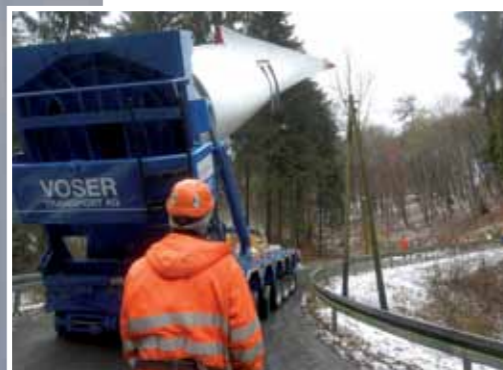
Alt und neu für kurze Zeit am selben Standort: ENERCON E-40 und E-82 auf dem «Hollandskopf» (Bild links). Rotorblatttransport mit dem Alpin-Gestell (mitte). Bild rechts: Ankunft eines Turmsegments per Selbstfahrer auf der Baustelle.
