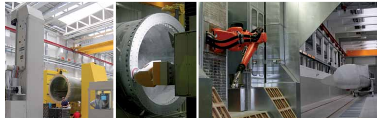
Beispiele für Automatisierung in der KTA: das Fräszentrum zur Bearbeitung der Blattflansche (Bilder links und mitte) und das Lackierportal, in dem die E-101 Blätter vollautomatisch lackiert werden.
