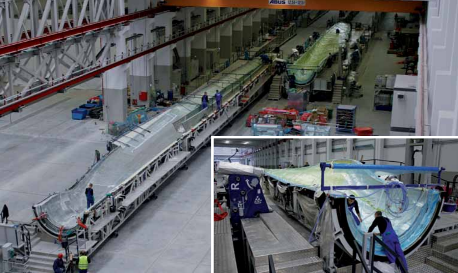
Neue Generation der Rotorblattfertigung: Die E-101 Blätter werden in der KTA auf sogenannten Formenfahrzeugen von einer Bearbeitungsstation zur nächsten transportiert.
