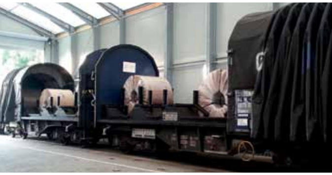
Ankunft von Stahlcoils bei ENERCON in Aurich. Für den Transport der Rollen setzt die e.g.o.o. spezielle Coil-Waggons ein.
