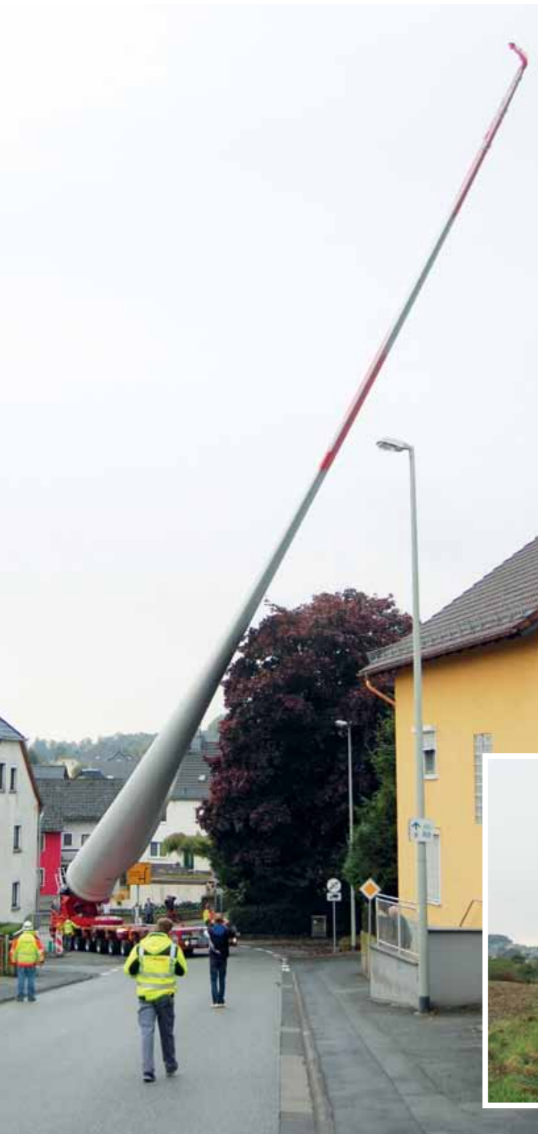
Selbstfahrer mit E-101 Rotorblatt im Alpin-Transportgestell.
