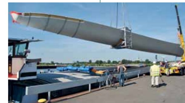
Verladung eines fertigen E-101 Rotorblatts aufs Binnenschiff im Eurohafen in Haren.
