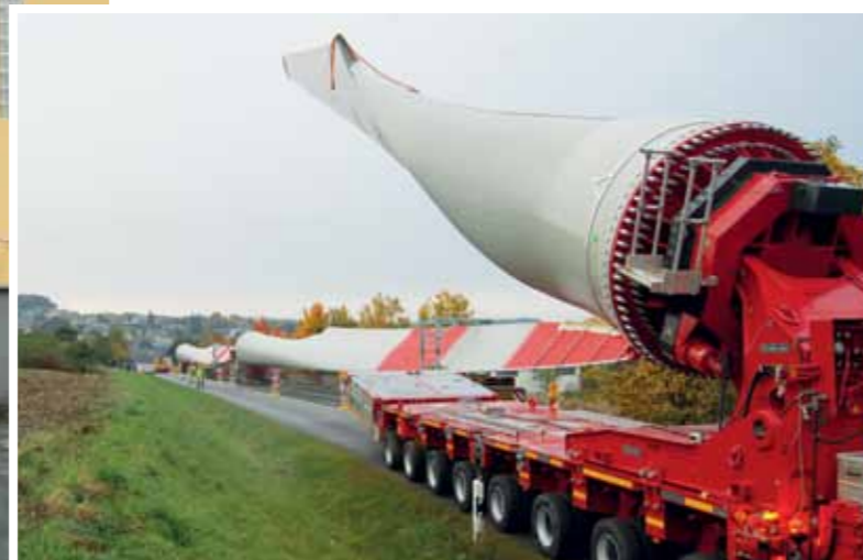
Selbstfahrer mit E-101 Rotorblatt im Alpin-Transportgestell.
