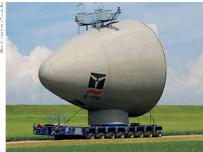
Transport eines vormontierten E-126 Maschinenhauses im Windpark NOP.
