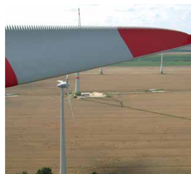
E-115 Rotorblatt mit Trailing Edge Serrations (TES).
