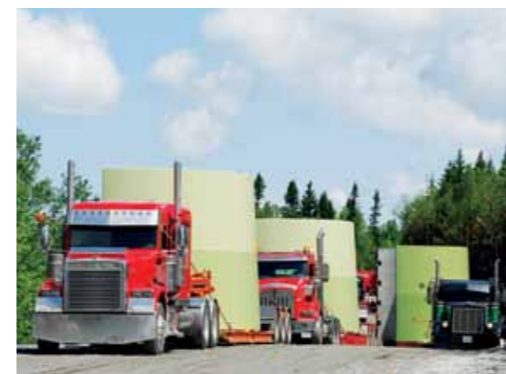
Turmsegmenttransport für Windenergie-Großprojekt in Quebec/Kanada.
