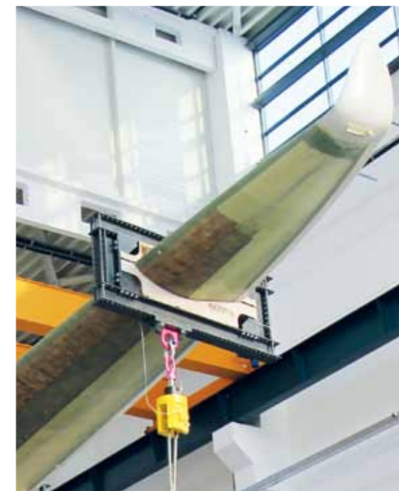
Versuchsanordnung für einen statischen Test: Die Zugkräfte werden mit Hilfe von Hydraulikzylindern, Stahlseilen und Umlenkrollen in das Blatt eingeleitet.
