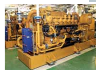
Neue Dieselgeneratoren zur Stromerzeugung an Bord: Nach Einbau der neuen Aggregate (Bild oben) hat ENERCON das «E-Ship 1» wieder in den Transportdienst genommen.
