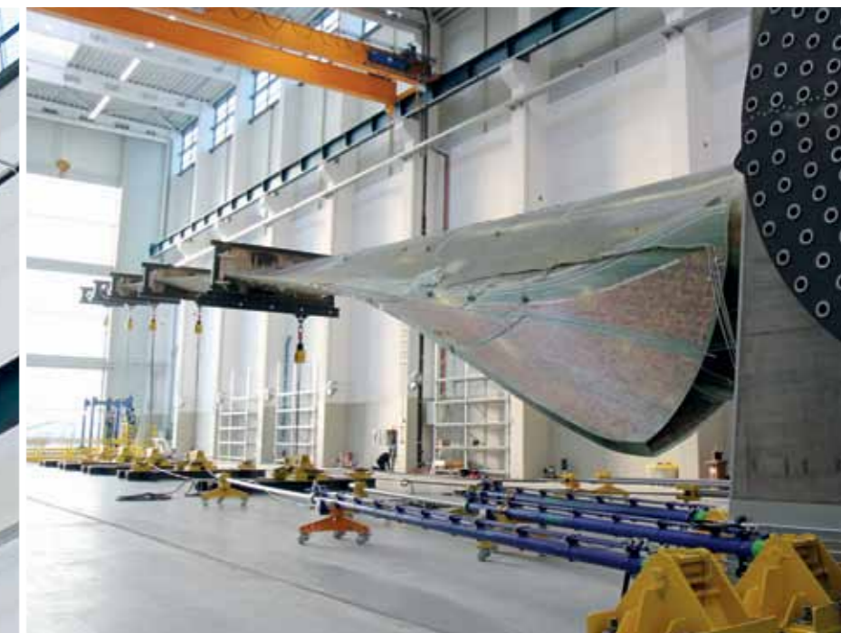
Versuchsanordnung für einen statischen Test: Die Zugkräfte werden mit Hilfe von Hydraulikzylindern, Stahlseilen und Umlenkrollen in das Blatt eingeleitet.
