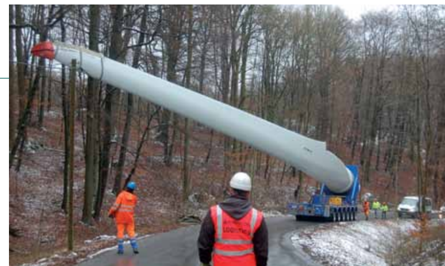
E-82 Rotorblatt auf dem Alpin-Transportgestell, das sich bereits in den Schweizer Alpen bewährt hat.
